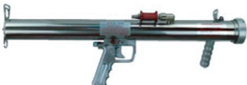
Он изготовлен из нержавеющей стали и состоит из камеры сжатия, быстродействующего запорного клапана, рукоятки со спусковым механизмом и камеры с водой или огнетушащим веществом. Приводится в действие воздухом, сжатым под давлением 25 бар. При открытии клапана сжатый воздух выталкивает огнетушащее вещество из ствола на высокой скорости за несколько миллисекунд. Скорость выстрела 430 км/ч (120 м/с) и большая охлаждающая поверхность обеспечивают высокую эффективность борьбы с огнем на расстоянии.
