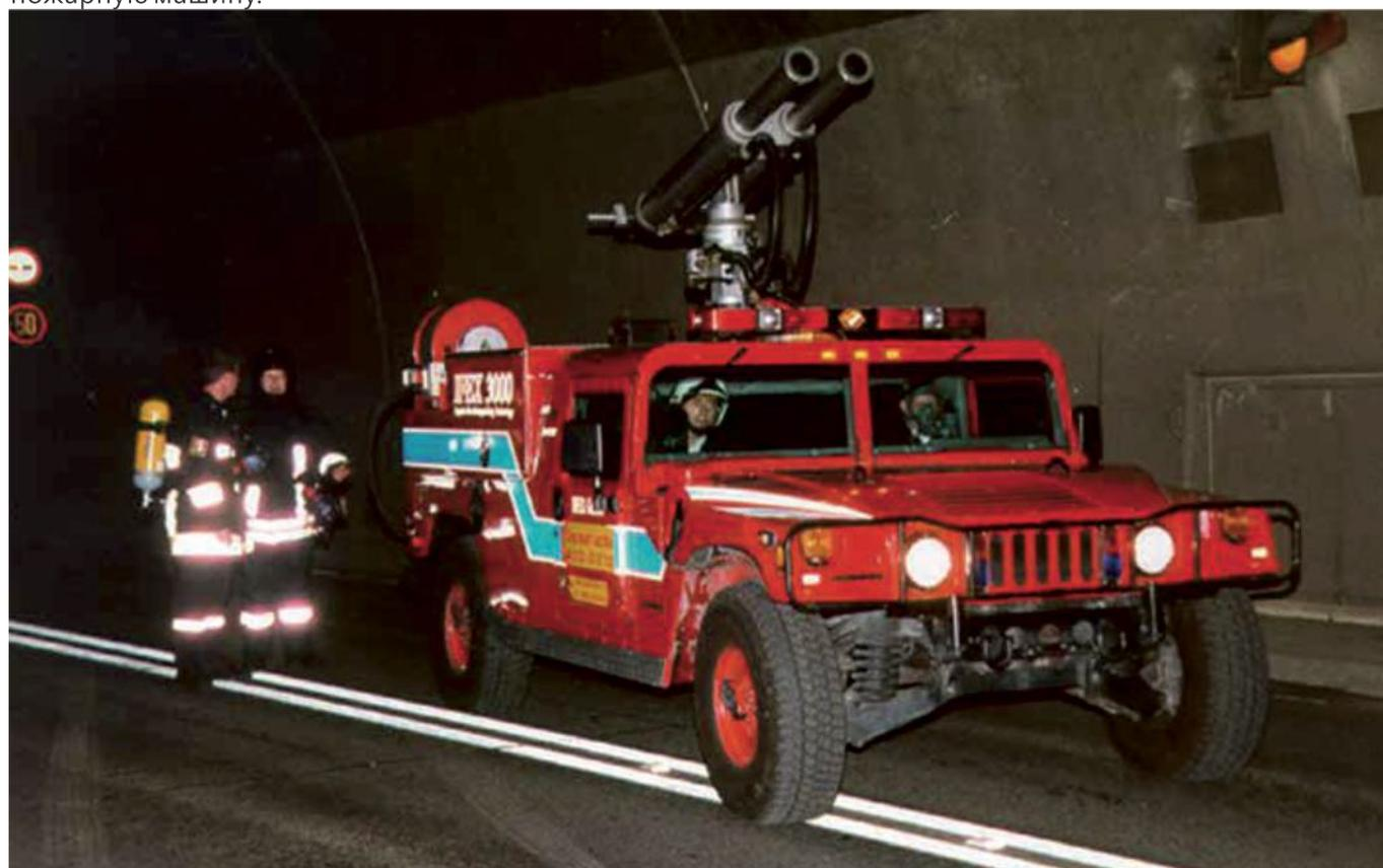
*Хаммер в качестве аварийной машины для тушения пожаров в туннеле (2x12 литров Dual-Intruder)*
