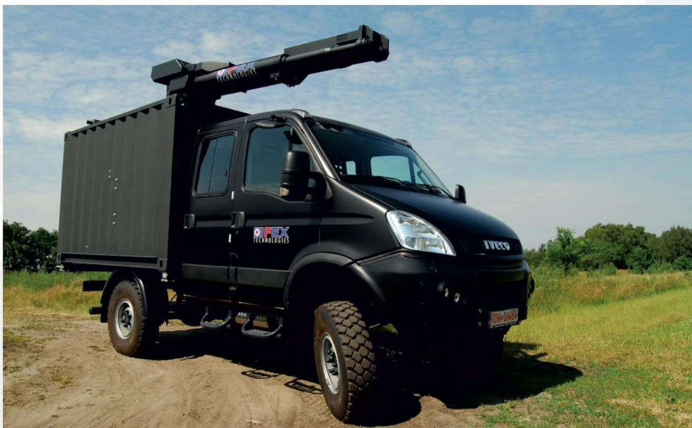
Система пожаротушения IFEX на кроссовере IVECO
