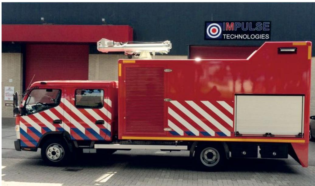
Автомобиль быстрого реагирования (АБР - FAU) 2x12 л Intruder (радиус действия 50 метров)
